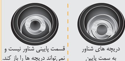
شکل ساختاری مخزن شناور
